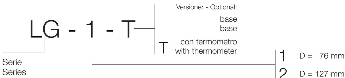
Gli indicatori di livello della serie LGN del tipo con o senza termometro sono costruiti in acciaio o alluminio e vengono forniti con guarnizioni di tenuta in gomma nitrilica antiolio.
